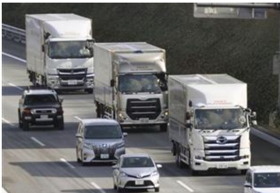
図4-5 トラック3台の高速道路の隊列走行実験
