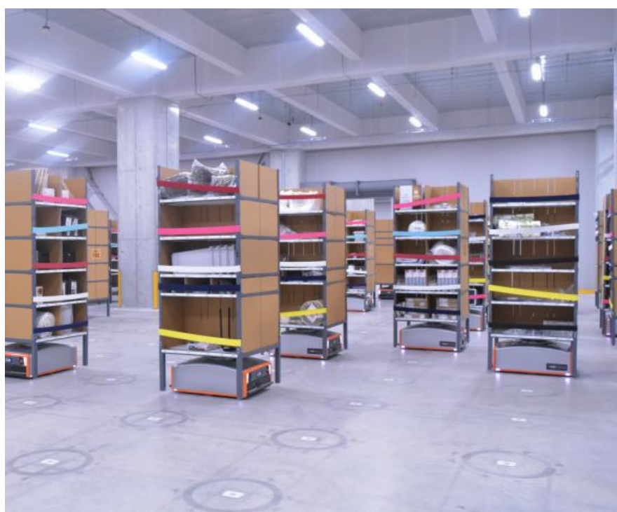
図4-2 稼働中のパトラー
