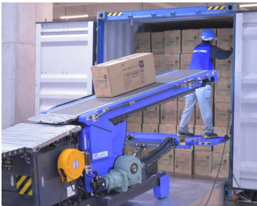
図4-3 作業中のデバンニングマシーン
